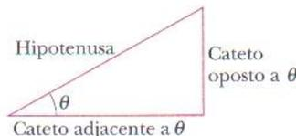
**FIG. 3-12** Triângulo usado para definir as funções trigonométricas. Veja também o Apêndice E.
