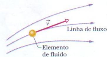
**FIG. 14-15** Um elemento do fluido traça uma linha de fluxo ao se deslocar. O vetor velocidade do elemento é tangente à linha de fluxo em todos os pontos.
