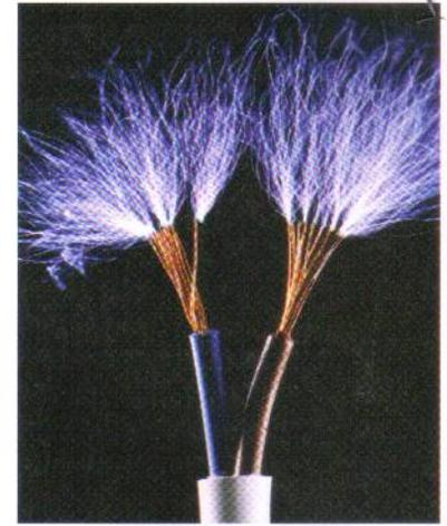
**FIG. 22-16** Centelhas aparecem na extremidade de condutores metálicos quando os campos elétricos produzidos pelos fios provocam a ruptura dielétrica do ar. (Adam Hart-Davis/Photo Researchers)
