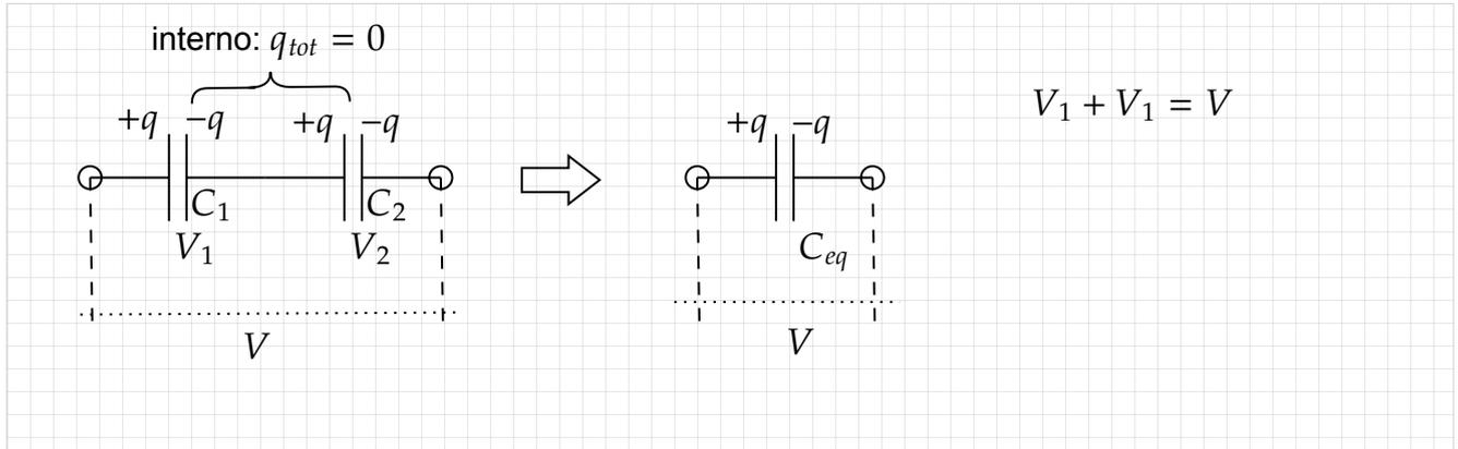
Aqui, a carga nas placas de cada capacitor ( $C_1$  e  $C_2$ ) são as mesmas:
