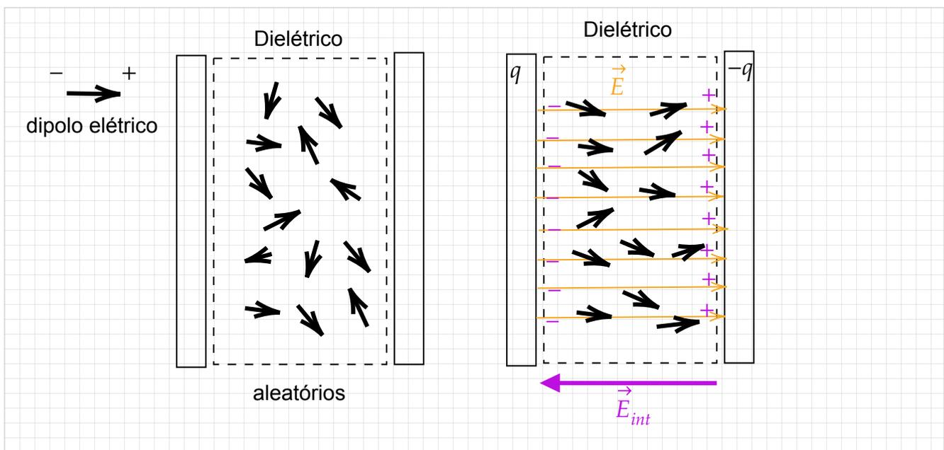
A orientação dos dipolos elétricos internos **efetivamente coloca novas cargas** próximos às placas.
