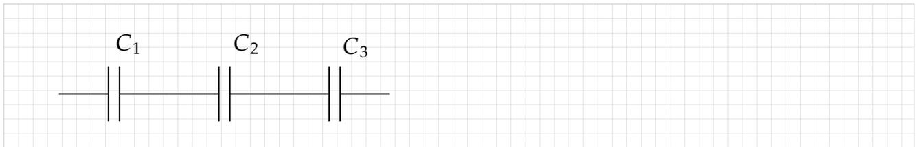
Média Harmônica:  $\frac{1}{C_{eq}} = \frac{1}{C_1} + \frac{1}{C_2} + \frac{1}{C_3}$ ,
