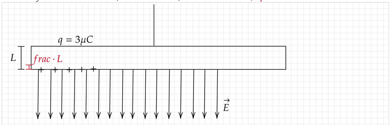
Os elétrons que carregam um capacitor vêm de uma região ínfima do condutor!
