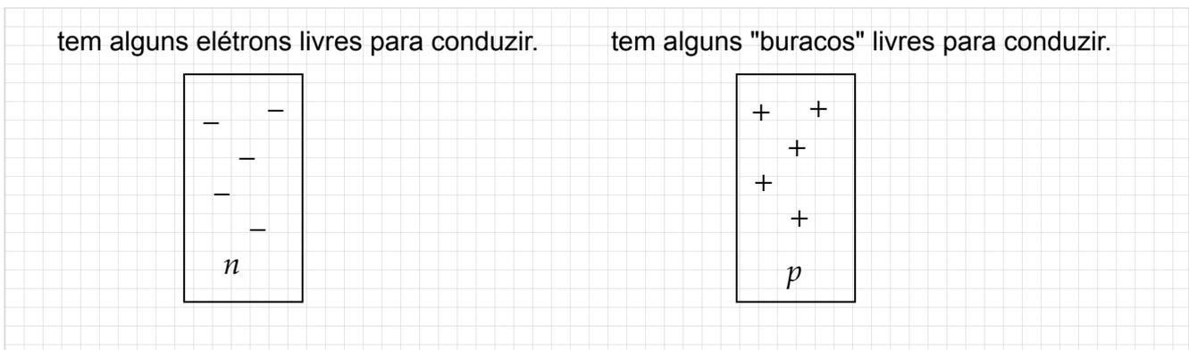
Vamos construir um DIODO. Este é um componente que conduz eletricidade APENAS em uma direção. Este é o componente que aparece na penúltima figura.
